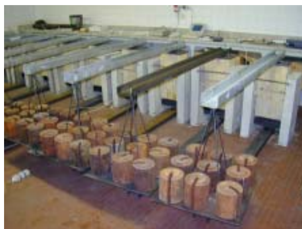
Figura 6. Fotografia dei provini disposti nella camera climatica durante la prova di viscosità.
