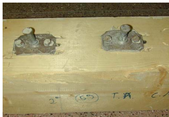
Foto 5 Scorrimento dei connettori a prova conclusa
