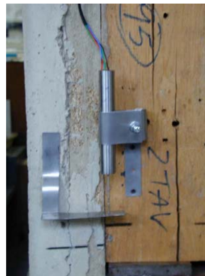
Foto 4 Particolare del trasduttore lineare per il rilievo dello scorrimento
