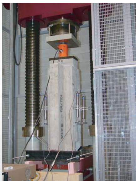
Campione strumentato predisposto all'esecuzione della prova. Le prove, in assenza di una normativa apposita per calcestruzzo, sono state condotte secondo EC4
