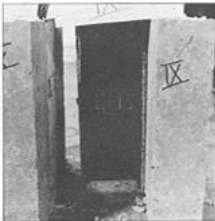
Figure 25 Collasso dei campioni tipo C1
